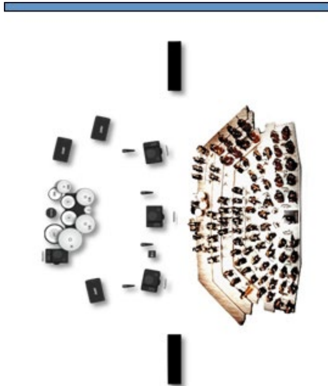
Tipica configurazione di un evento live dove è montato un Sistema PA stereo
